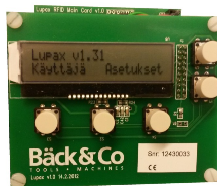
Lupaxmodul sedd från insidan av box med display för programmering och uppföljning av användare.
